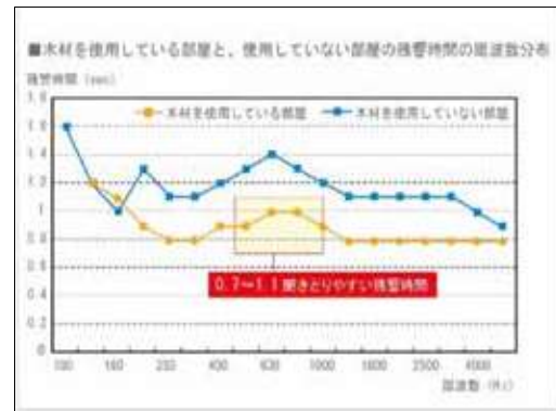
木材を使用している部屋と使用していない部屋の残響時間の周波数分布
