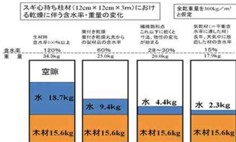
図1-7 乾燥に伴うスギ柱材重量の変化
