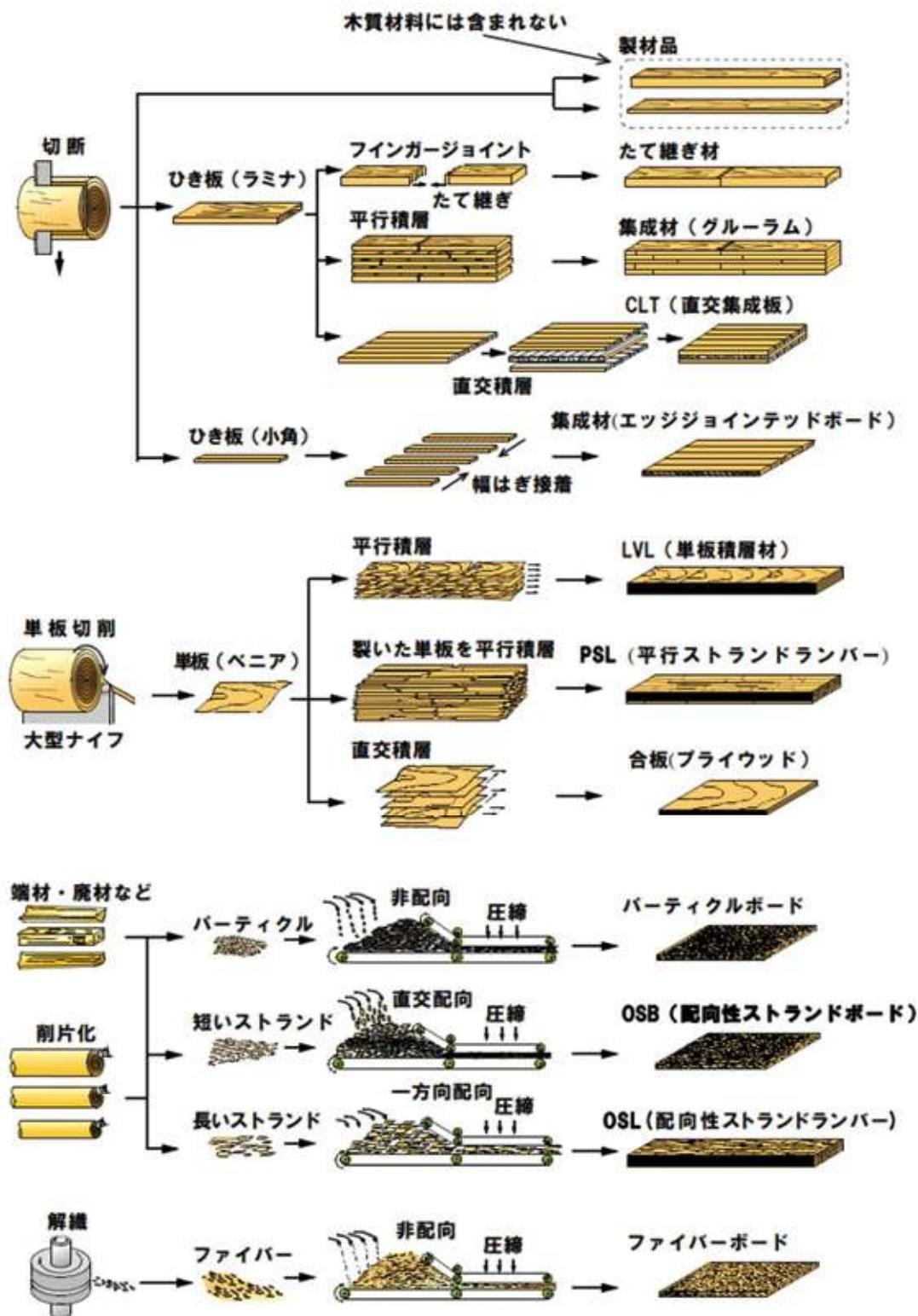
図 1-6 代表的な木質材料とその製造工程の概略図（原料→エレメントに分解→再構成→製品）
